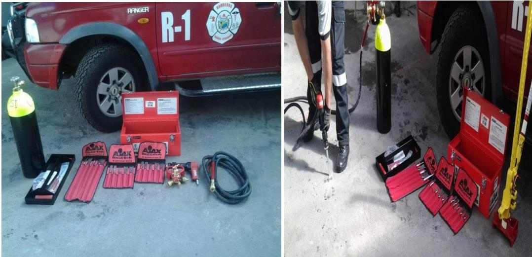
Se adquirió equipo de corte y penetración neumático; el cual nos permite cortar en láminas de hierro y acero como también en concreto de alta resistencia.
